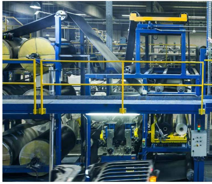
BITUMINOUS MEMBRANE PRODUCTION LINE - DANOSA, SPAIN
